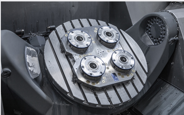
Das VERO-S-Nullpunktspannsystem auf dem Maschinentisch sorgt für eine hohe Wiederholgenauigkeit beim Palettenwechsel und ist optimal auf alle Anforderungen in der Automatisierung angepasst.
