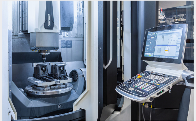
Das 5-Achs-Fräszentrum DMU75 monoBLOCK mit PH Cell 300 ist mit dem Nullpunktspannsystem VERO-S sowie mit Spannpaletten und verschiedenen Spannmitteln ausgestattet.
